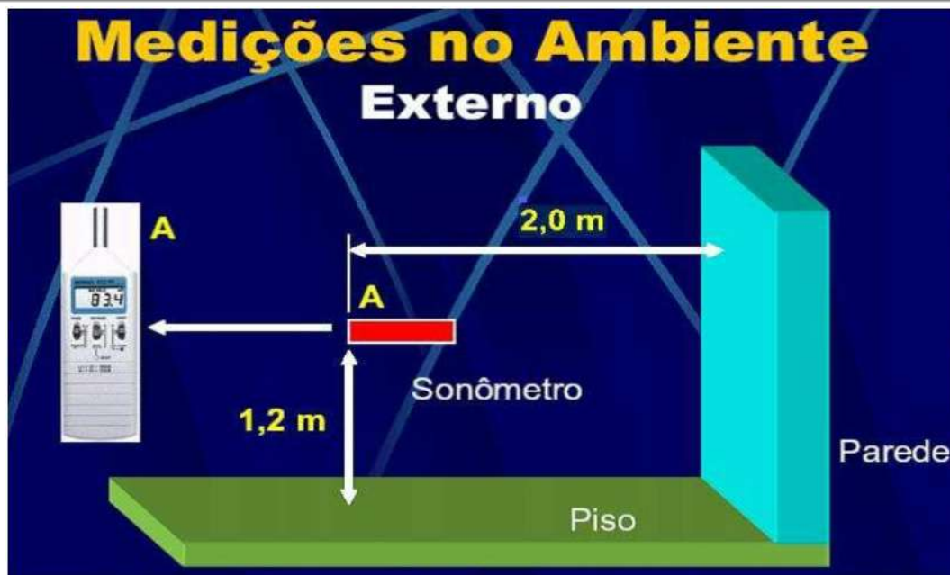
Figura 1 - Condições básicas para medições de nível de ruído em ambientes externos.
