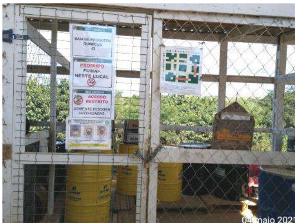
Foto 101 – Baia de produtos químicos no pátio da oficina mecânica. (Data:04/05/2021)
