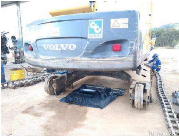
Foto 121 – Acionamento do plano de contingência em vazamento de equipamento. (Data:18/05/2021)
